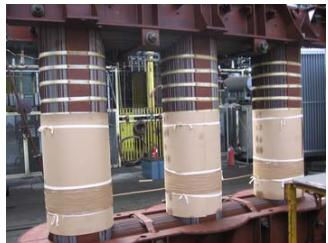
Slika broj 7 Foto-snimak magnetnog kola transformatora sa VN strane
