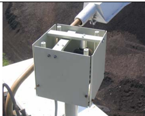
Sl.3b. Unutrašnji izgled prijemnika opterećenja
