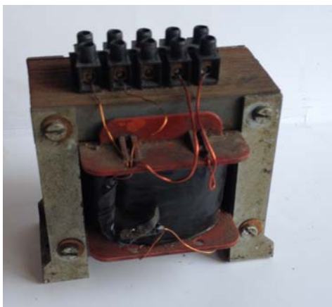
Slika 9. Transformator koji je korišćen za simuliranje kvarova
