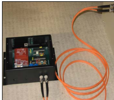
Slika 9. Optički link za VN merenja
