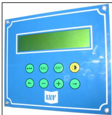
Slika 12. Spoljni izgled displeja za lokalno komandovanje sekcijama elektrofiltera
