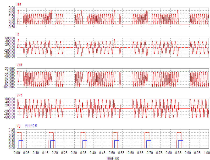
Slika 3. Vremenski dijagrami koji ilustruju rad jednofaznog elektrofiltera u intermitentnom režimu i pri probouju
