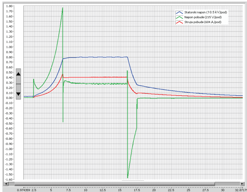
Slika 4. Dinamika pobuđivanja i razbuđivanja generatora u ručnoj regulaciji pobude
