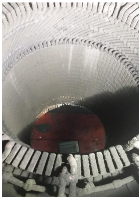
Slika 1. Izgled statora motora posle kvara Slika 2. Izgled rotora motora posle kvara
