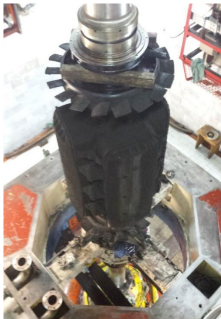
Slika 1. Izgled statora motora posle kvara Slika 2. Izgled rotora motora posle kvara
