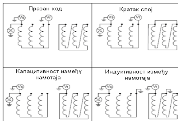
Слика 5: Мерне шеме при СФРА мерењу
