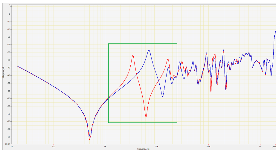
Слика 12: Фреквентни одзиви намотаја Т-3 у фази „В“ за случај отвореног и затвореног темена троугла намотаја терцијара – 2018. година
